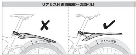
注 意 ディフェンダー XC11の 取付け角度を調整する際には ディフェンダーXC11とタイヤ の間隔をホイール可動量より 多くなるようにしてください。 不正確な角度と間隔は ディフェンダーXC11や 自転車を破損させたり、ケガを 負ったりする恐れがあります。
